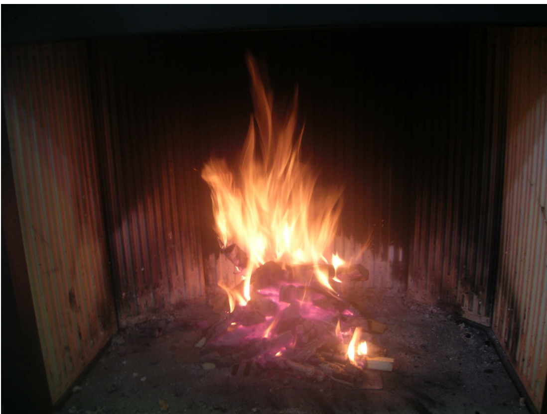
Figura 5 – Caminetto aperto – combustione dopo 15 minuti dall'accensione (8/3/2012 – h. 9.30)
